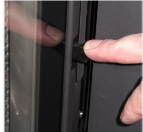
Иллюстрация 3: Öffnen der Feuerungstür zur Reinigung
