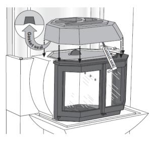
**17.** Откройте дверцы топки и аккуратно посадите два огнеупорных уплотнителя в направлении снизу вверх, на каждой стороне между передними боковыми плитами и чугунными деталями (Стрелка 13).
