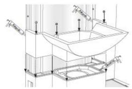
**8.** Нанесите полоску клея Gasket seal толщиной 10 мм по окружности по всей монтажной поверхности внутренней полки, внутри внешней полки.
